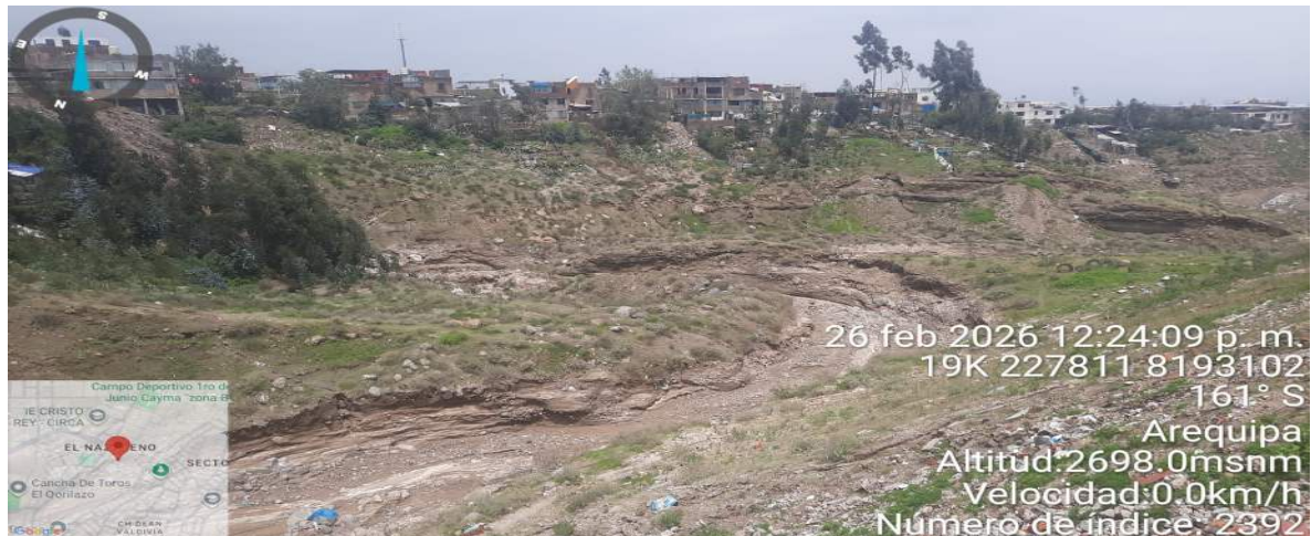
IMAGEN 01: SE MUESTRA LA COLMATACION DE LA QUEBRADA S/N DONDE SE PROPONE CONSTRUIR 03 DIQUES TRANSVERSALES PARA MITIGAR LA EROSION Y
